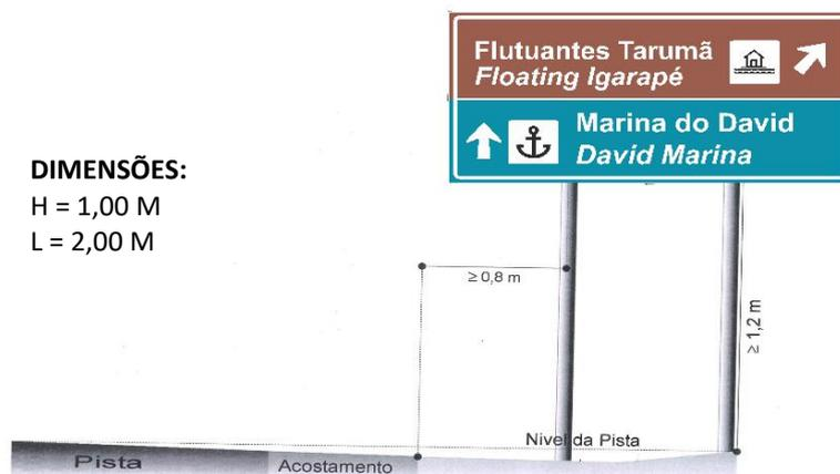
Tubo de aço carbono com diâmetro de 2", parede 2,65 mm. Na base do tubo é soldado um aço redondo de construção para engasgar no concreto, melhorando a fixação e proporcionando o anti-giro. Deverá ser galvanizado eletroliticamente ou galvanizado a fogo.
