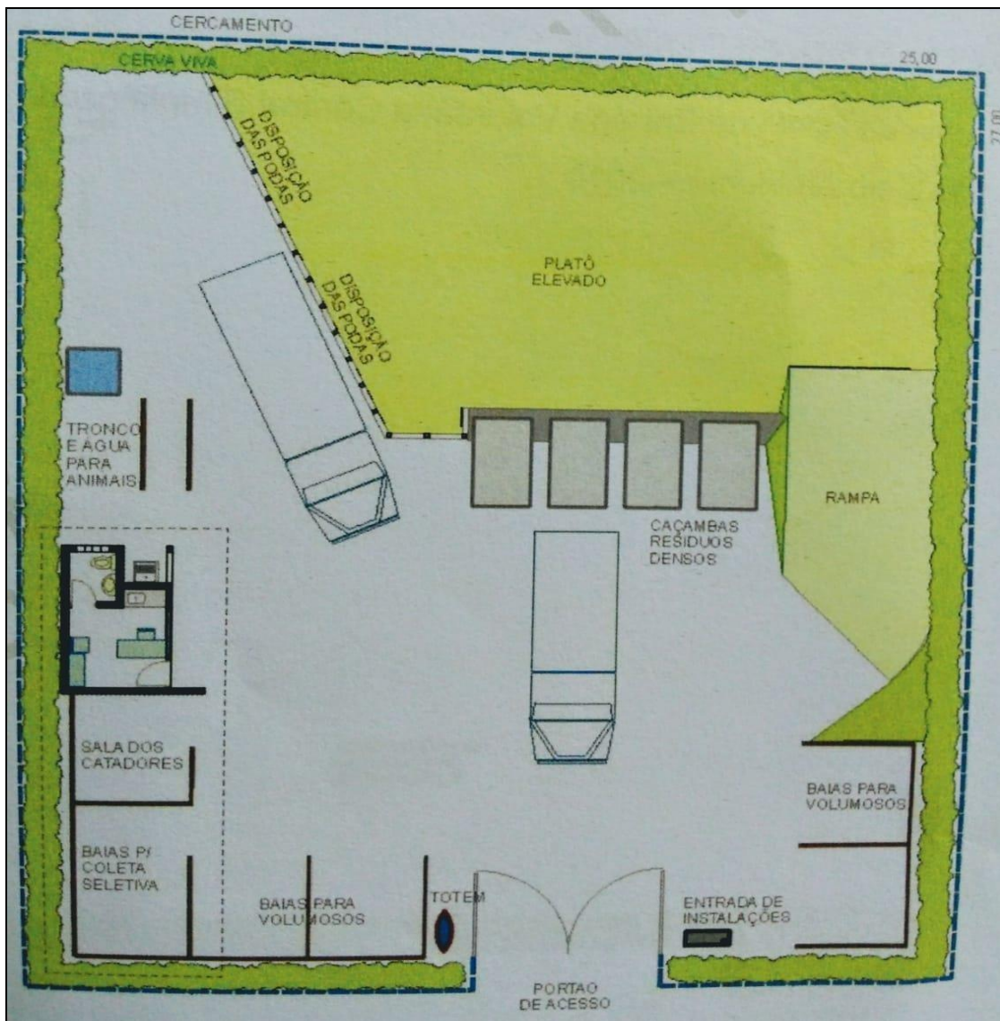
Figura 2: Esquema do Ponte de Entrega Voluntária Central Simplificado (PEV Simplificado).
